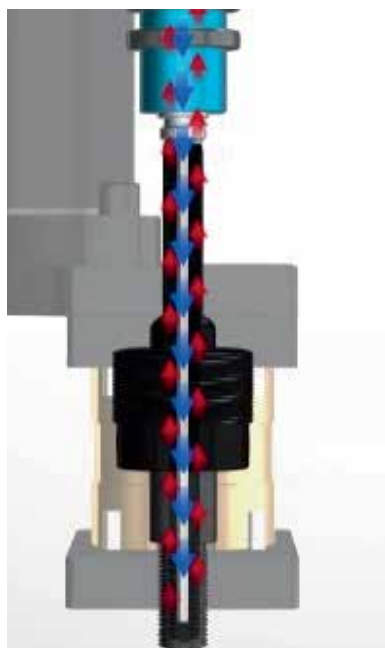
Funktion Kernkühlung Beispiel Gewindeausschraubeinheit
